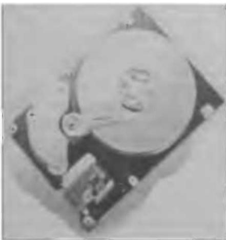
Основой винчестера является алюминиевый диск толщиной около 1,9 мм, на который нанесен ферромагнитный рабочий слой толщиной 0,6—1,2 мкм.
